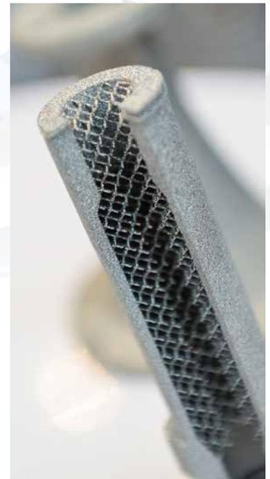
Additiv gefertigte Komponente für die chemische Verfahrenstechnik des ZMP, Fürth auf der Material Innovativ
