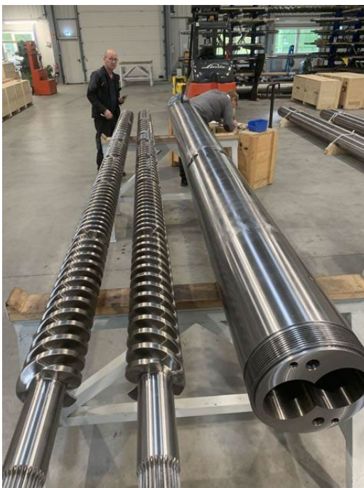
Zwei Extruderschnecken und der zugehörige Doppelschneckenzyylinder im WAFO-Werk Pirmasens. WAFO ist ein führender Hersteller solcher Komponenten. / Foto: WAFO
