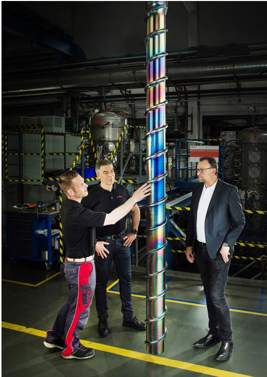
WAFO-Chef Andreas Wagner, Michael Bilo von Oerlikon Balzers und Sascha Jackes (v. rechts), Produktionsleiter im Oerlikon Balzers Kundenzentrum in Bergisch Gladbach, begutachten eine beschichtete Extruderschnecke für WAFO. / Foto: Oerlikon Balzers
