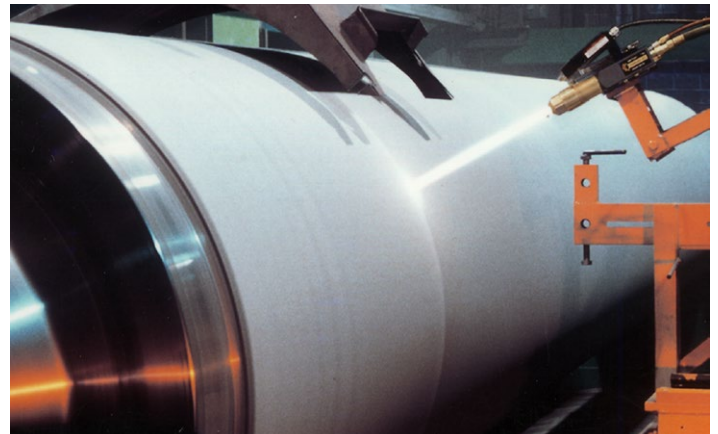
Bild 22 – HVOF Beschichtung einer Potrolle
