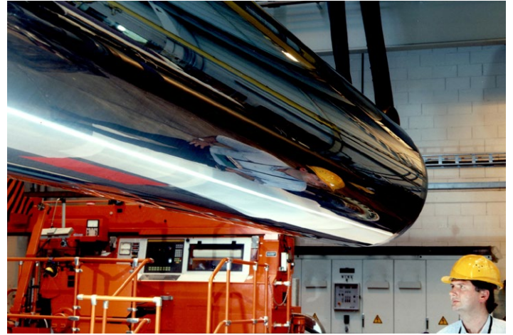
Bild 23 – Metco™CAL Beschichtung nach dem Polieren
