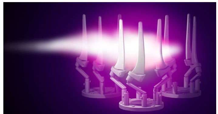
Bild 6b – VPS Plasmaspritzen
