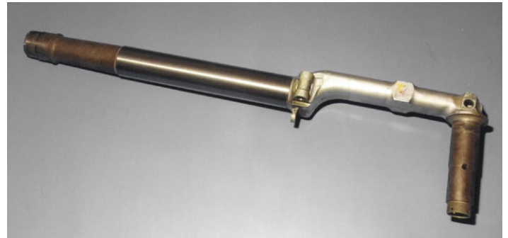
Bild 14 – Bugfahrwerk eines F5 Tigers mit WC/CoCr Beschichtung
