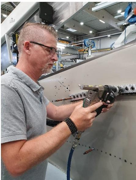
Von 80 auf 250 Bohrungen: Eine BALDIA-Diamantschicht ermöglichte eine signifikante Verbesserung der Standzeit eines One-Shot-Bohrers beim Bearbeiten von CFK im Flugzeugbau und reduzierte damit die Werkzeugkosten um mehr als die Hälfte.
