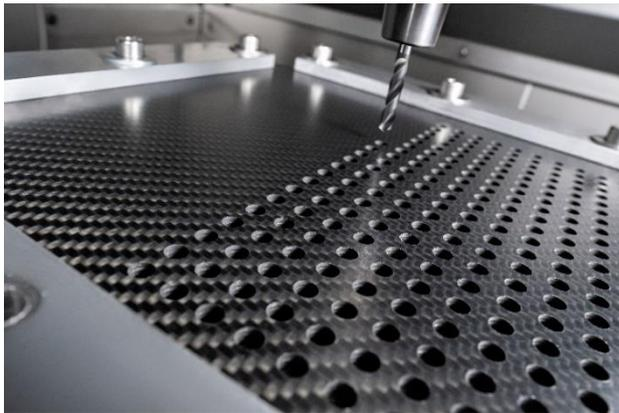
Kohlefaserverstärkter Kunststoff (CFK) ist leicht und robust, doch seine effiziente Zerspanung stellt eine große Herausforderung dar. Diamantbeschichtungen bieten hier eine ideale Lösung. Sie müssen jedoch je nach Anwendung sehr enge Bohrtoleranzen einhalten, die im Labor genau unter die Lupe genommen werden.
