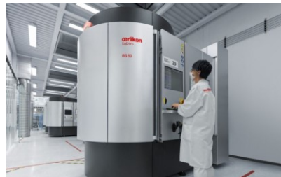
Die RS 50 beschichtet Flugzeug-Komponenten von Airbus in Ferrières-en-Brie in der Nähe von Paris, einem bedeutenden, für die Luftfahrt zertifizierten Produktionszentrum von Oerlikon Balzers.
