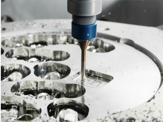
Bei den Tests im ibb-Labor bearbeiteten mit BALIQ TISINOS PRO beschichtete Speedfräser auch spezielle Prüfkörper in CoCr-Blanks, um die Maßhaltigkeit des Resultats zu messen. / Foto: Oerlikon Balzers
