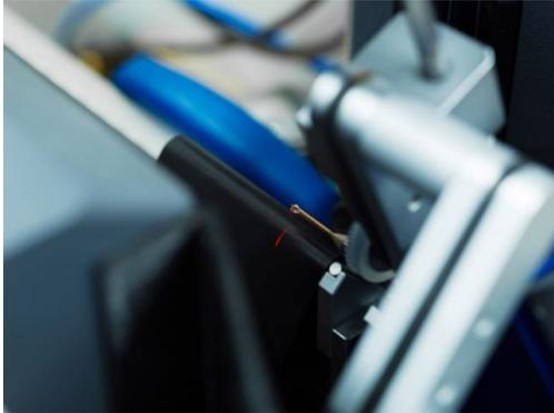
*Zur Kontrolle der Fertigungsergebnisse wird der Speedfräser mittels Lasermikrometer im Mikrometerbereich auf perfekten Rundlauf und Durchmesser geprüft Foto: Oerlikon Balzers*
