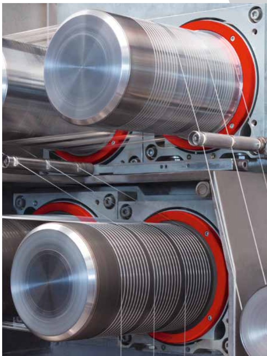
从喂入到冷却鼓的绝对直丝路径改进了生产工艺。
