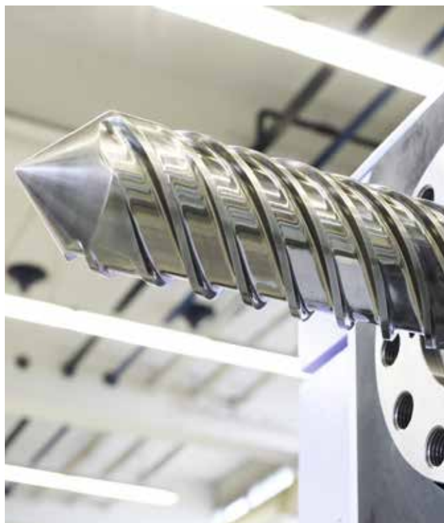
所有挤出机的核心：螺杆。
