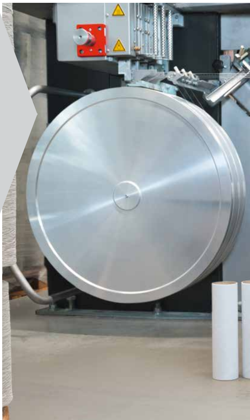
采用新型Witras III-37卷绕机，可将工艺速度提高至3,700米/分钟。
