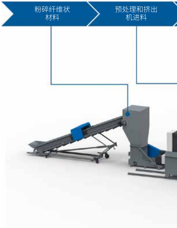
连接VarioFil纺丝生产线的VacuFil Visco + 在线纤维至纤维回收生产线的工艺步骤。
