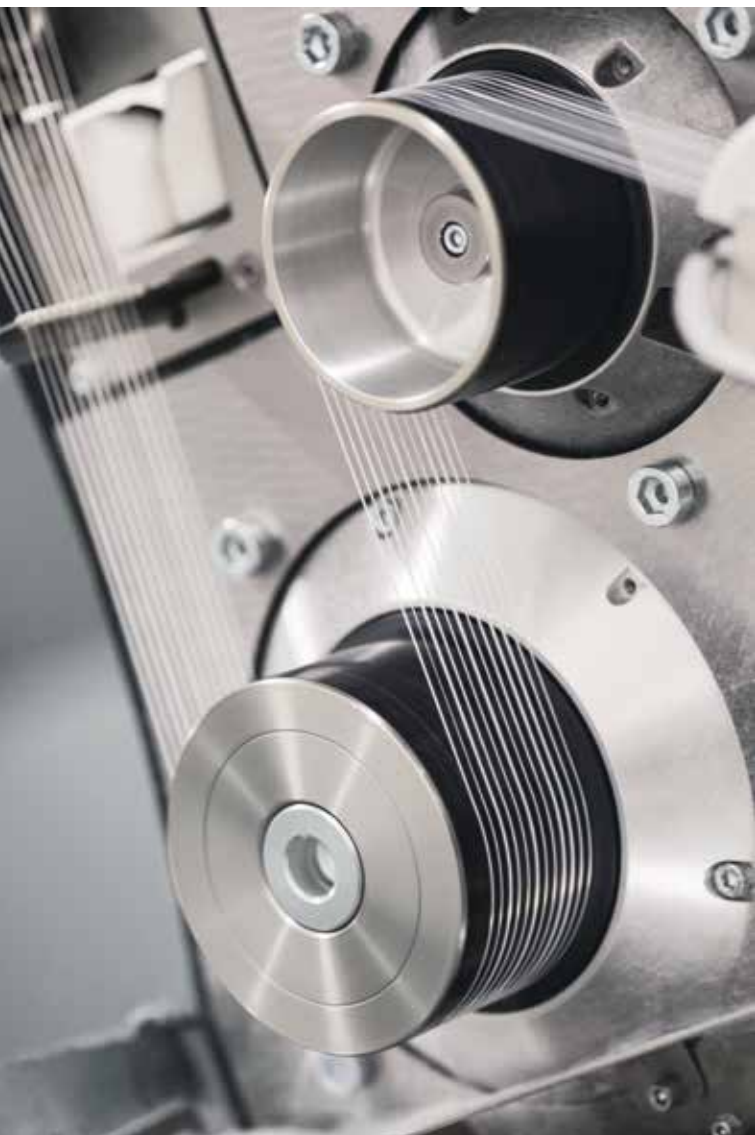
非常适合粗旦丝的高效生产工艺: 欧瑞康巴马格WINGS HD, 满卷丝饼保护时间更长。
