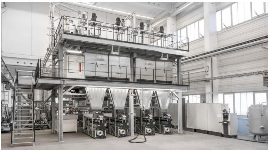
图: 欧瑞康巴马格的首条回收饮料瓶制造 POY 丝线生产设备
