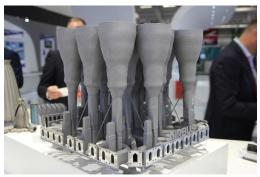
A Oerlikon AM fornece soluções para fabricação aditiva de componentes metálicos, incluindo esses conjuntos de antenas de alumínio usados nos satélites de comunicação da Airbus. / Imagem: Oerlikon
