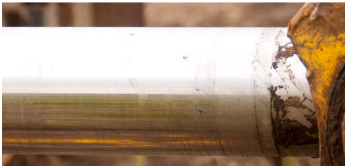
Hydraulik-Kolben: Hartverchromt, nach 682 h Einsatz
