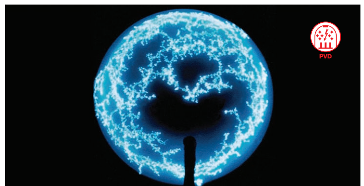
PVD Target im Arc-Prozess
