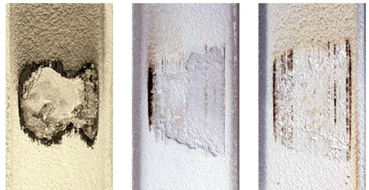
初始叶片材料转移后的严重涂层破坏
