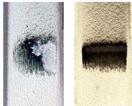
混合涂层破坏和叶片材料转移
