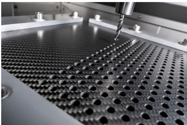
碳纤维增强塑料（CFRP）重量轻且坚固，但有效加工它们构成了重大挑战。金刚石涂层提供了一种理想的解决方案，尽管对于某些应用，它们必须满足非常严格的钻孔公差，这些公差在实验室中经过仔细检验。
