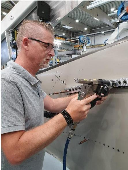
从 80 个孔到 250 个孔：BALDIA 金刚石涂层显著提高了用于飞机制造中加工 CFRP 的一次性钻头的使用寿命，将工具成本降低了一半以上。
